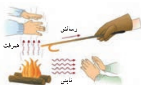
شکل ۴-۲۵ هر سه روش انتقال گرما را در این تصویر مشاهده می‌کنید.
