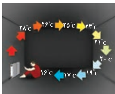
شکل ۴-۲۸ گرم شدن هوای اتاق به روش همرفت
